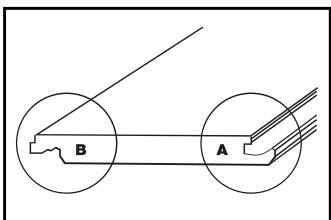
Начните укладку первого ряда с дальнего левого угла помещения. Укладывайте так, чтобы обе стороны половицы с гребнем (B) были обращены к стене. Начиная укладку, установите распорки для соблюдения расстояния до стены.
