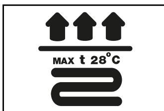
Теплые полы на базе регулируемых пленочных электронагревателей могут быть пригодны для использования с ламинированными полами, если изготовитель нагревателя обеспечивает, что температура поверхности никогда не превысит 28°C. Стандартные теплые полы на базе пленочных электронагревателей при экстремальных перепадах температуры вырабатывают температуру поверхности, намного превышающую 28°C, и поэтому считаются непригодными в качестве основания для укладки.
