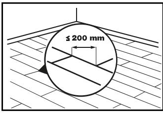
3. Сборку второго и последующих рядов начните с соединения половиц ряда между собой по поперечной стороне.
