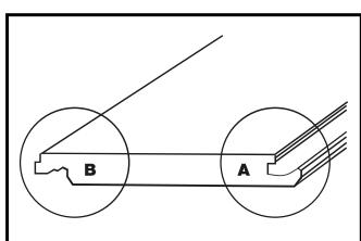
Почніть укладання першого ряду з дальнього лівого кута приміщення. Укладайте так, щоб обидві сторони мостини з гребенем (В) були звернені до стіни. Починаючи укладання, встановіть розпірки для дотримання відстані до стіни.
