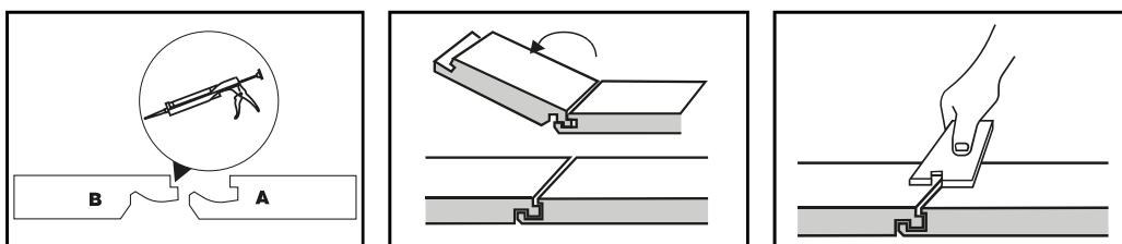
Увага! Переконайтесь, що після нанесення клею між мостинами не залишилося зазорів.
