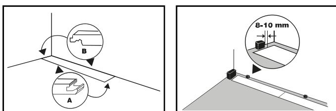
Збирайте ряд, з'єднуючи мостини по поперечній стороні одна з одною, у такий спосіб: до першої та кожної наступної покладеної мостини прикладайте нову, під кутом вводячи її гребенем у паз уже покладеного елемента. Потім мостину, що укладається, опускайте до тих пір, поки вона повністю не ляже на підлогу.
